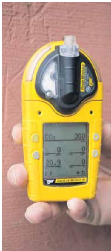
Lebensretter: das Gaswarngerät für Gasbildung unter der Erde
